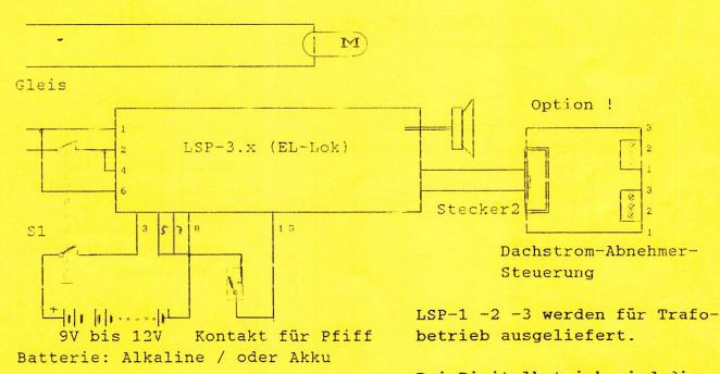
Bei Digitalbetrieb sind die S1 = 2-poliger Umschalter Einbau-Hinweise zu beachten.
