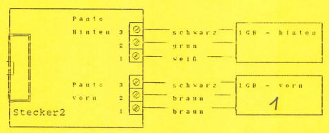
Achtung! Motoranschluβ rot/schwarz tauschen (umpolen) - nur bei einem Panto-Antrieb.
